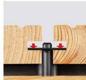
„GECKO-Befestigungssystem“ für Terrassenbeläge mit seitlicher Nut. Bestehend aus glasfaserverstärktem, witterungs- beständigem Kunststoffkreuz mit Edelstahlplatte und vormontierter Edelstahlschraube. Perfekte Optik und gleichmässiger Dielenabstand. Mit Abstand zur Unterkonstruktion, keine Staunässe dank optimaler Hinterlüftung.
