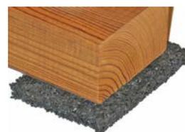
Gummigranulatunterlage, bildet einen Abstand zwischen Unterkonstruktion und Fundament, für eine gleichmässige Lastverteilung, gleicht kleine Unebenheiten aus, wirkt trittschallhemmend, nimmt keine Feuchtigkeit auf und wird unterlegt, wenn die Balken quer zur Wasserflussrichtung verlegt werden.
